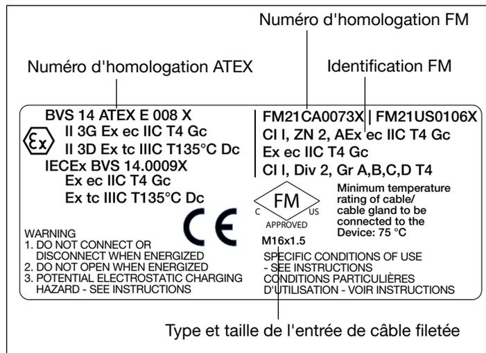
Fig. 4 : Exemple d'étiquette autocollante d'homologation variant PR07
