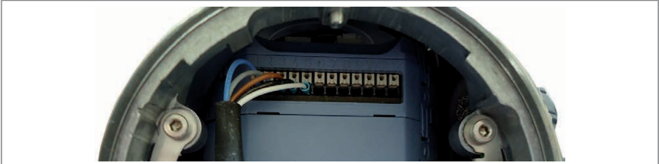
Abb. 24: Verkabelung der 12-poligen Anschlussklemme ab Werk
