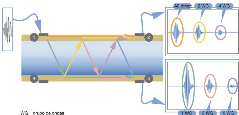
Esta figura muestra como ejemplo las señales recibidas, cómo se producen, cuando solamente emite el transductor interdigital 1. La estimulación de uno de los emisores genera unas ondas acústicas de superficie con una frecuencia superior a 1 MHz.
